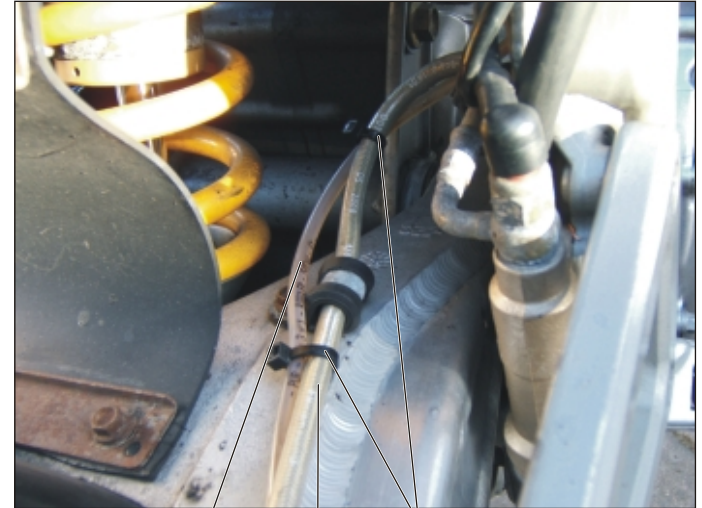
Bild 10 Verlegung der Ölleitung parallel zur Bremsleitung nach oben zur Steuerung
