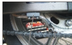
Bild 8 Befestigung der Schlauchhalterungen an der Schwinge
